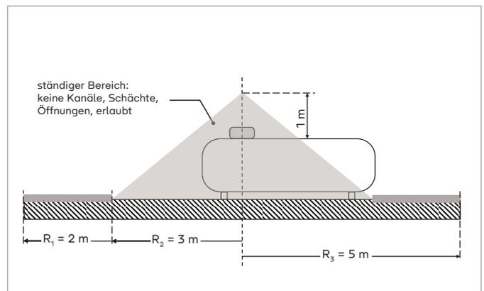
Bei oberirdisch aufgestellten und erdgedeckten Flüssiggasbehältern dürfen bei Haushaltsanlagen im Abstand von 3 m um betriebsbedingte Freisetzungstellen (Peilventil und Füllanschluss) keine offenen Kanäle, gegen Gaseintritt ungeschützten Kanaleinläufe, offenen Schächte, Öffnungen zu tieferliegenden Räumen (Kellerschächte) und Luftansaugöffnungen vorhanden sein.
