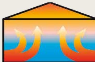
Bei herkömmlichen Heizungen zieht die erwärmte Luft nach oben aus dem nutzbaren Bereich ab.
